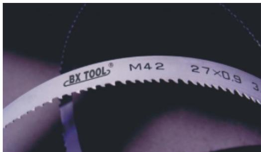
M42 - это тип быстрорежущей стали биметаллической пилы предназначенной для пиления основных марок сталей твердостью до 40-45 HRC. Твердость режущих кромок зубьев 67 – 69 HRC. Содержание 8% кобальта и 2% карбида вольфрама увеличивает стойкость режущей кромки.
